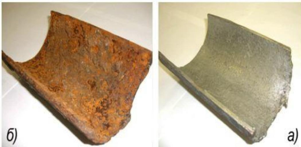
3-rasm. Metall sirtini boshqa metallar bilan qoplash usullari.
