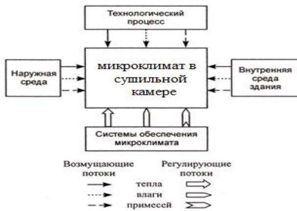
Рисунок 1. – Структурная схема формирования микроклимата в сушильной камере
