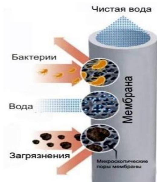
Мембранная очистка воды предполагает прогон жидкости через специальную полупроницаемую пленку. Это эффективные методы очистки воды, но качество полученной жидкости зависит от размера пор мембраны. [13]
