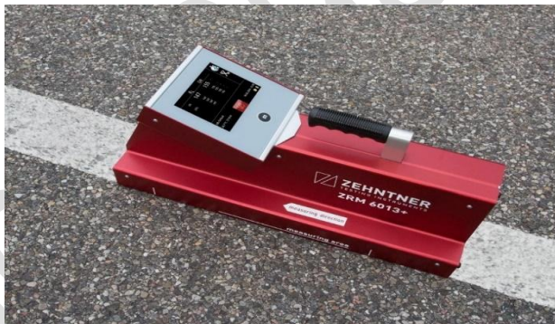
2-rasm. “Bobur” ko‘chasida Zehntner ZRM 6013+ RL/Qd retroreflektometri yordamida o‘lchash jarayoni.
