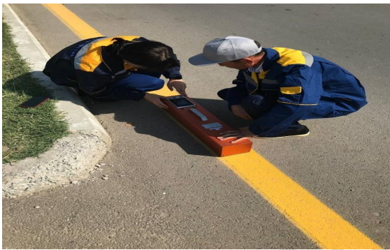
2-rasm. “Bobur” ko‘chasida Zehntner ZRM 6013+ RL/Qd retroreflektometri yordamida o‘lchash jarayoni.
